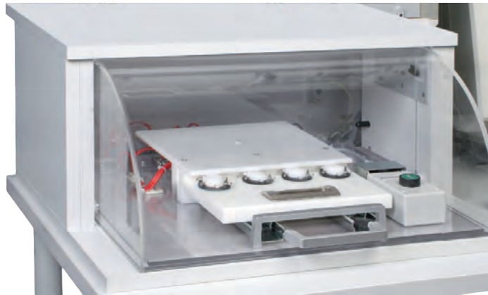
Das Foto zeigt ein Beispiel mit einer kundenspezifischen Prüflingsaufnahme aus hochspannungsfestem Delrin, in dem jeweils 4 mit Kunststoff umspritzte Leiterbahnen für die Automobilindustrie eingelegt werden können.
