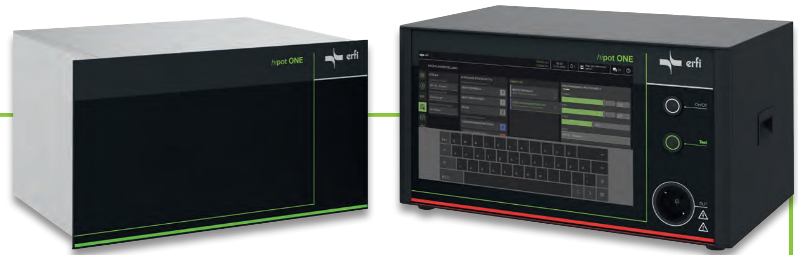
Einzelprüfgerät als Automatenversion, 6 HE/19“-Einschub für Prüfanlagen
