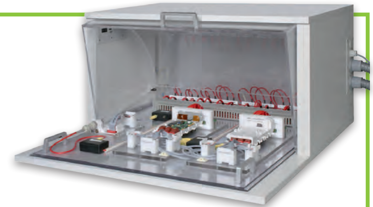
Die Abbildung zeigt die Prüfhaube mit der serienmäßig integrierten Bodenplatte und einem darauf montierten Prüflingsadapter für medizintechnische Geräte.
