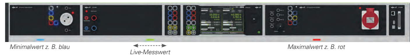
Beispiel: Messwertdarstellung, Anzeige/Überwachung der Grenzwerte
