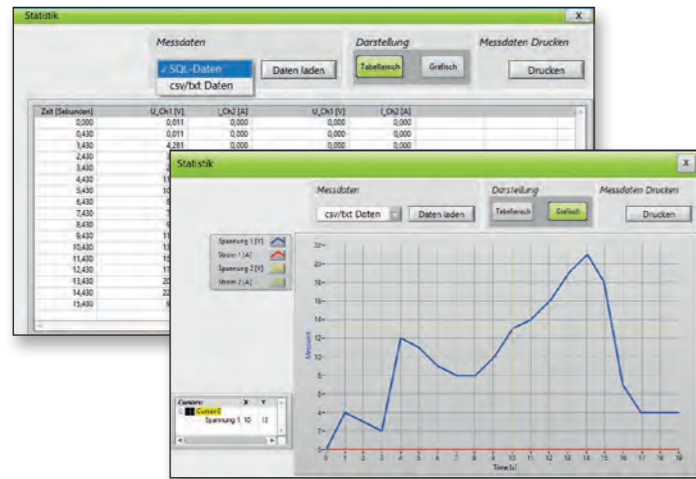
Beispiele: Grafische und tabellarische Messwertdarstellung. Die Messdaten werden während des Messvorganges in einer Tabelle und gleichzeitig in einer Grafik visualisiert. Über einen Befehl wird ein HTML-Reporting für einen Internetbrowser erstellt.
