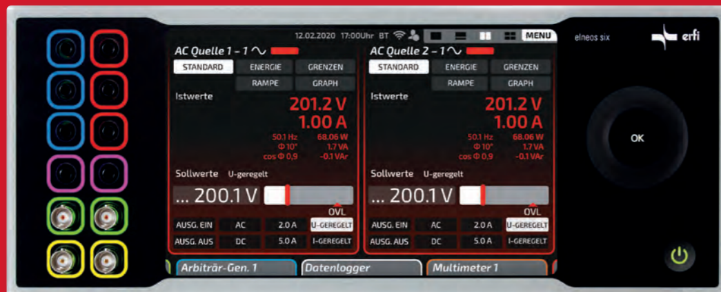
Halbscreen: Beispiel der gleichzeitigen Gerätedarstellung von zwei AC-Quellen im Halbscreen-Modus. Alle anderen Geräte bleiben durch die Gerätaufleiste am unteren Bildschirmrand erreichbar.
