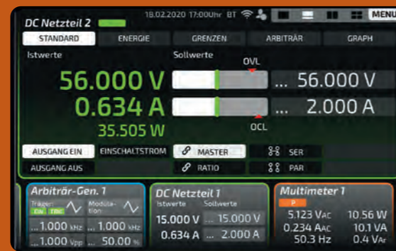
Effiziente Nutzung aller Gerätegruppen: Selbst wenn sich der Leistungsmesser im kleinen Sekundärbereich befindet, kann zwischen Leistungsmessung und Digitalmultimeterfunktionen umgeschaltet werden.
