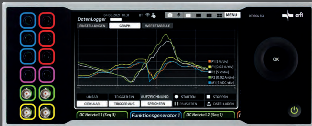
Messwertdarstellung: Der Datenlogger erlaubt die gleichzeitige und synchronisierte grafische Darstellung von 5 unterschiedlichen Messgrößen bzw. Geräten inkl. X-Y-Zoom- und Scrollfunktion. Einzelne Kurven sind dabei zudem ausblendbar.
