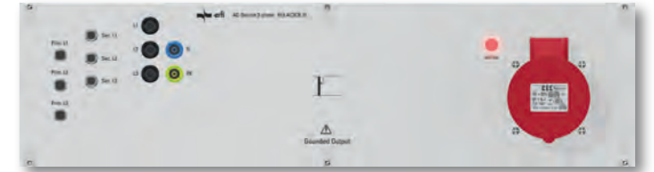
Zusatzeinschub mit Alufrost für AC-Quelle 3-phasig, nicht erdfrei, 3 HE/95 TE Ausgänge (abges.): 5 SLB 1 , 1 CEE-Steckdose 16 A Anzeige: RGB-LED für Ausgang active Best.-Nr. EL6.AC3CB.31
