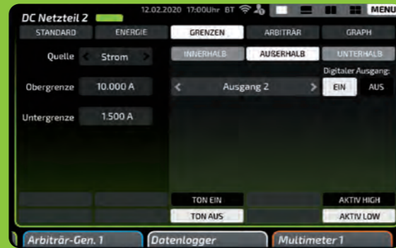
Limitier: Der Limiter erlaubt die freie Überwachung von Spannungs- und Strombereichen in Verbindung mit Grenzen. Jeder Zustand kann mit einem akustischen Signal und einem frei wählbaren digitalen Ausgang gekoppelt werden.
