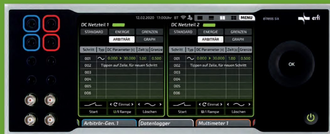
Unabhängige Programmierung: Dank variabler Bildschirm-aufteilung können Doppelleistungsarbiträrgeneratoren unabhängig voneinander programmiert werden.
