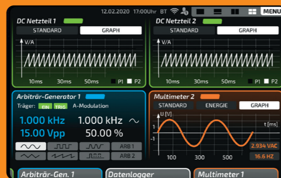
Quattro-Screen: In jedem der Splitscreens bleibt das Gerät bedienbar. Auch die grafische Messwertdarstellung kann im kleinsten Screen (Quattro-Screen) parallel zu anderen Geräten wie z.B. DC-Netzteilen oder AC-Quellen parallel genutzt und bedient werden.
