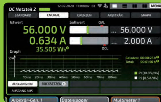
Energiesmessgerät: Die neuen Regelnetzgeräte erfassen jederzeit die Leistung grafisch und numerisch.
