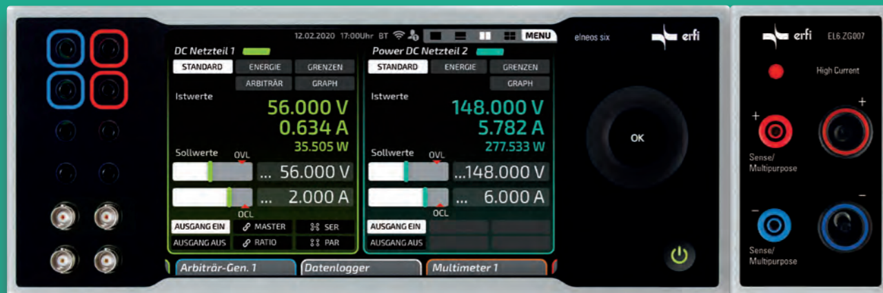
Kombinatorik: Selbst in Kombination mit den längsgeregelten Netzteilen (hier NT1) arbeiten die Powernetzteile problemlos zusammen.
