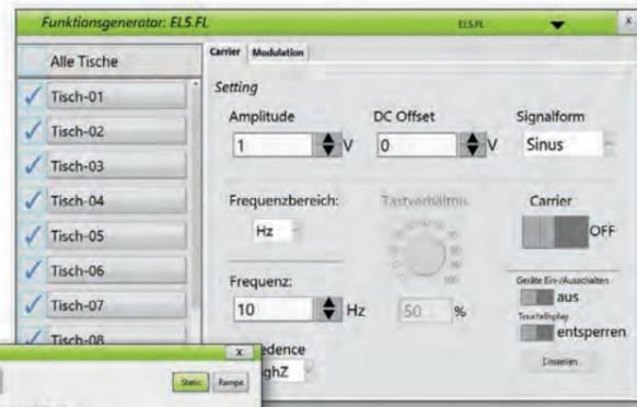
Gleichzeitige Detailsinstellung der Funktionsgeneratoren an allen Labortischen.
