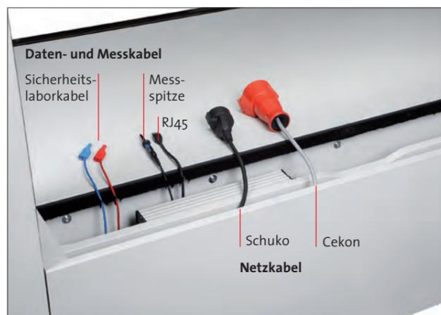
Gute Zugänglichkeit durch Mittenstellung. Die Kabelsortierung bleibt während der Öffnung und Schließung dauerhaft gewährleistet.
