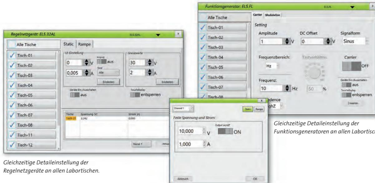
Gleichzeitige Detaileinstellung der Regelnetzgeräte an allen Labortischen.
