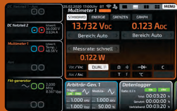
Leistungs- und Energiemessung: Der Leistungs- und Energiemesser in Fullscreen-Modus mit Anzeige aller relevanten Energiewerte sowie der Wirkenergie und den Crestfaktoren für U und I inkl. Zoomfunktion.
