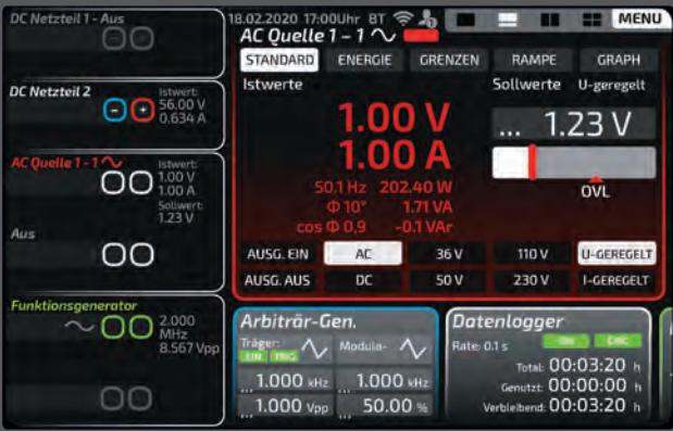
Connectionpanel mit Live-Messwertanzeige: Der restliche Screen wird bei Einblendung des Connectionpanels dynamisch skaliert und ist parallel immer bedienbar. Die Live-Messwertanzeige bleibt dauerhaft eingeblendet und ist fest positioniert (keine Verschiebung).
