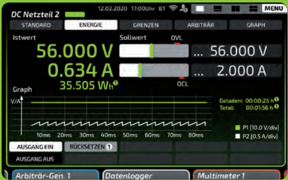
Energiemessgerät: Die neuen Regelnetzgeräte erfassen jederzeit die Leistung grafisch und numerisch.
