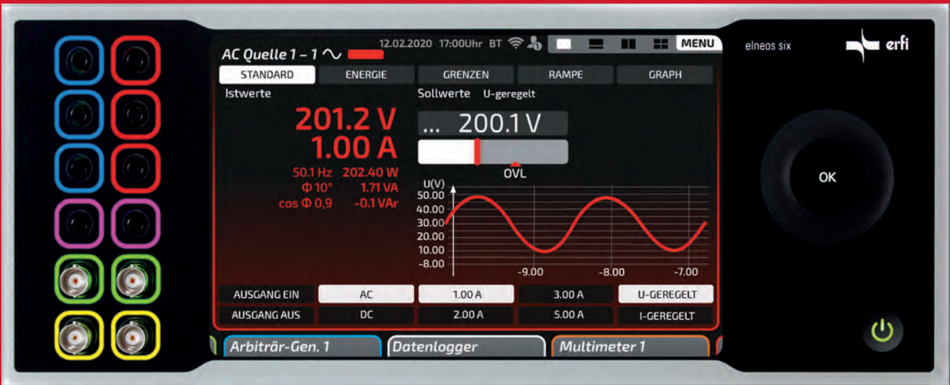
Standardansicht der 1-phasigen Quelle: Die Ansicht informiert zu jedem Zeitpunkt über alle Werte auch in grafischer Darstellungsform. Ein integrierter Leistungsmesser wertet zusätzlich die Wirk-, Schein- und Blindleistung sowie die Phasenlage aus.
