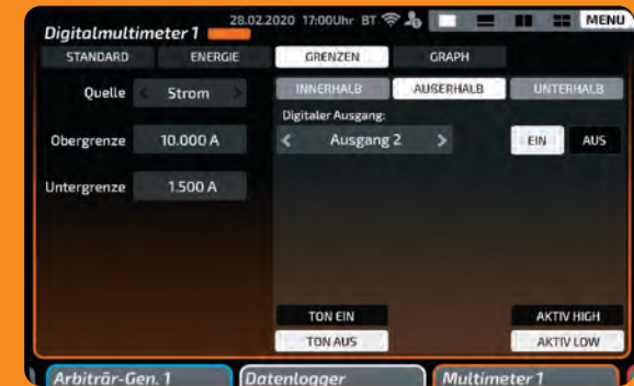
Limitier: Jede Messgröße kann durch definierbare Grenzen mittels Tönen und digitalen Ausgängen überwacht werden. Die digitalen Ausgänge können direkt genutzt werden, um beispielsweise verschiedene Zustände mittels dem erfi- RGB-Indikationslicht anzuzeigen.
