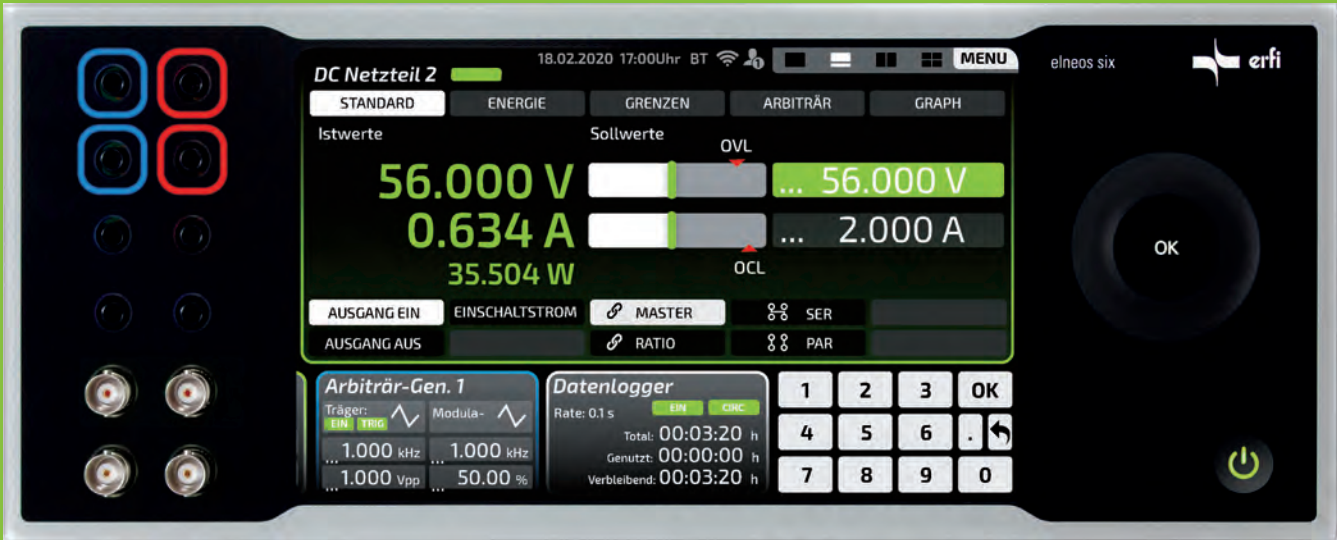
2/3-Screen-Modus: Regelnetzgerät im Hauptscreen, mit Leistungsanzeige und horizontalen Slidern zur Grobeinstellung.
