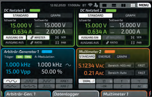
Quattro-Screen: mit Paralleleingabe in allen 4 Screens gleichzeitig.
