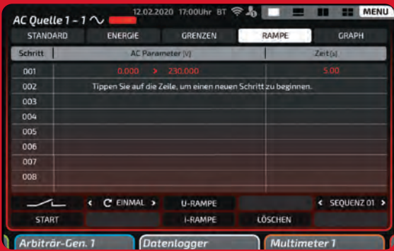
Rampengenerator: Durch das 8-Zoll-Display können beliebige Sequenzen ohne Programmieraufwand direkt eingegeben werden. Alternativ können die Sequenzen über die Schnittstelle übertragen und gestartet werden.
