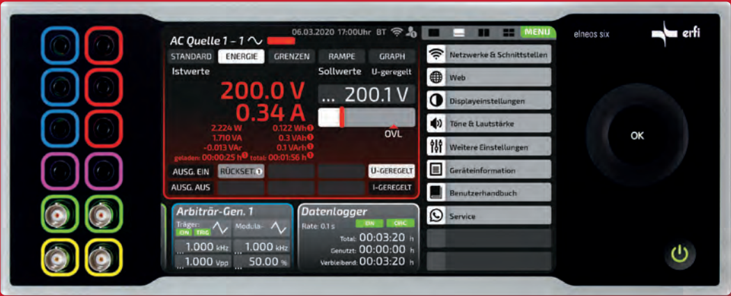
Dynamischer Screeninhalt: Die Screendarstellung passt sich allen Situationen dynamisch an, auch dann, wenn das Menü eingeblendet wird. Der AC-Screen skaliert sich auf die richtige Größe, so dass alle Informationen des Gerätes sichtbar bleiben.
