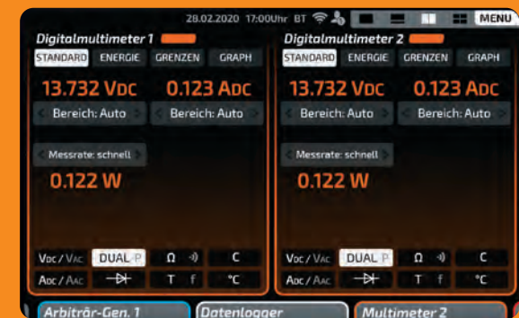
Zwei Digitalmultimeter im Halbscreen: Alle Bedienelemente beider Digitalmultimeter lassen sich gleichzeitig und unabhängig voneinander bedienen. Die optionale Dualmessung ermöglicht jedem Digitalmultimeter die gleichzeitige Erfassung von Strom und Spannung im AC und DC-Bereich.
