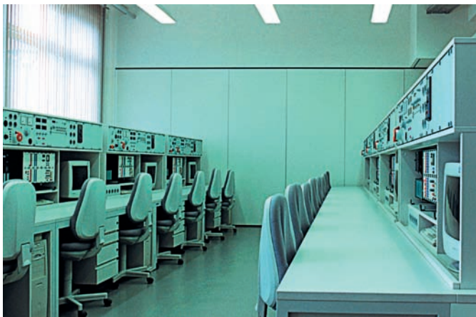
Versenktische mit Kombinationsaufbauten. Im unteren Bereich links ausgestattet mit dem Einsatzplattenprogramm acto, oberhalb Aufnahme für SPS-Steuerung. Diese Einheit kann komplett versenkt werden.
