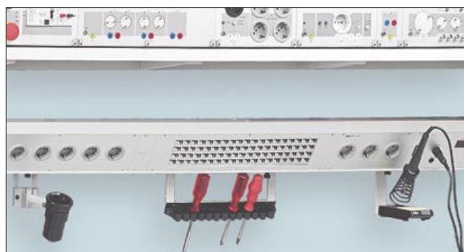
Über ein rückseitig adaptierbares Aluprofil lassen sich zusätzliche Funktionskomponenten wie Akkuschrauber, Werkzeughalter, Lochblechtafeln, Drehteller für Kleinteile, Geräteplattformen u.v.m. am Systemkanal anbringen. Durch die Lötcolbenablage schwebt der Kolben frei über der Tischfläche. Die Lötstation ist in den Systemkanal eingebaut. Dies erhöht den Freiraum auf der Arbeitsfläche und schafft Ordnung.
