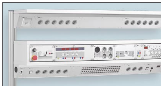
Beim Modultisch mit mehreren Ebenen lassen sich mehrere Systemkanäle für universelle Funktionen einsetzen. Das Beispiel zeigt im unteren Bereich einen Systemkanal mit Kurzfeldleuchte, Steckdosen und Lötstation, oben einen Systemkanal bestückt mit Steckdosen, Trenntrafo, Datensteckdose u.v.m.
