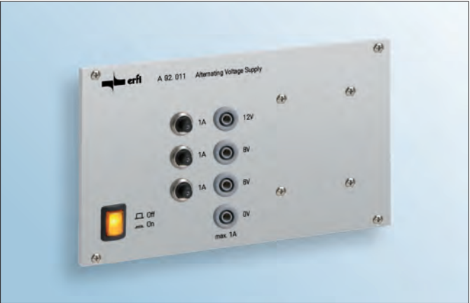
Kleinwechselspannungsmodul, erdfrei 6 V, 8 V, 12 V/ 1 A - 1 beleuchteter Netzschalter - 4 Sicherheitslaborbuchsen zur Entnahme erdfreier Klein-Wechselspannung - 1 thermischer Schutzscharter (primäre Absicherung) - 3 thermisch-magnetische Schutzscharter (sekundäre Absicherung)
