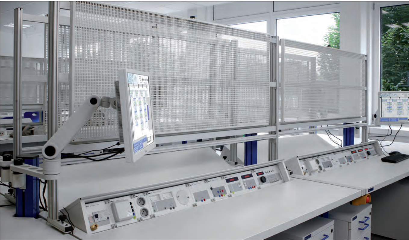
19"-highlab-Gerätesystem im 3HE/19"-Schwenkaufbau, verschiebbarer Experimentierahmen mit Lochblech.
