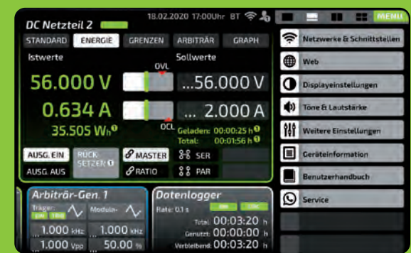
Menü-Leiste und dynamische Bildschirmskalierung: Bei Einblendung der Menü-Leiste schiebt sich der Screen dynamisch zusammen und bleibt während der Einblendung komplett lesbar und bedienbar. Störende Überblendungen von Menüs werden damit vollständig vermieden.
