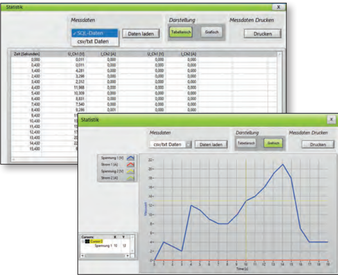
Beispiele: Grafische und tabellarische Messwertdarstellung. Die Messdaten werden während des Messvorganges in einer Tabelle und gleichzeitig in einer Grafik visualisiert. Über einen Befehl wird ein HTML-Reporting für einen Internetbrowser erstellt.
