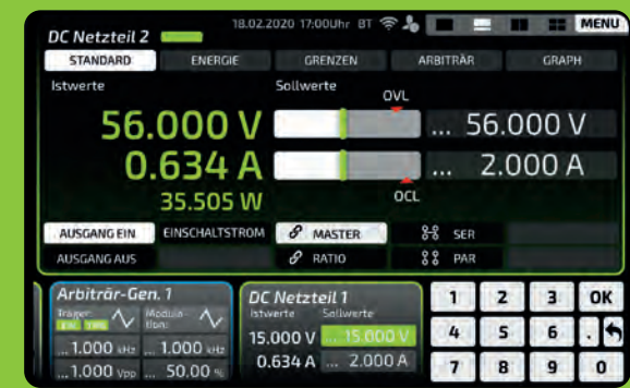
2/3-Screen-Modus: Regelnetzgerät im kleinen Fenster mit numerischem Tastaturfeld. Selbst in dem kleinen Fenster sind die Geräte bedienbar und es können Sollwerte eingegeben werden.
