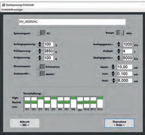
Prüfplan Hochspannung mit Umschaltmatrix.
