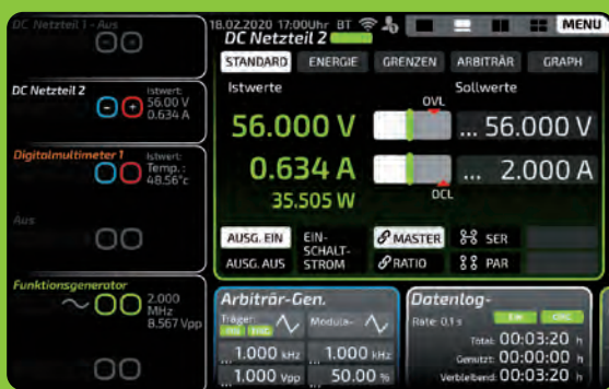
Connectionpanel und Bildschirmskalierung: Bei Einblendung der Connectionpanels wandern alle Screens nach rechts und passen sich in der Größe an. Gut sichtbar werden die Wertangaben im Connectionpanel der aktuellen Belegung dauerhaft dargestellt. Keine Verschiebung der Messwertanzeigen.
