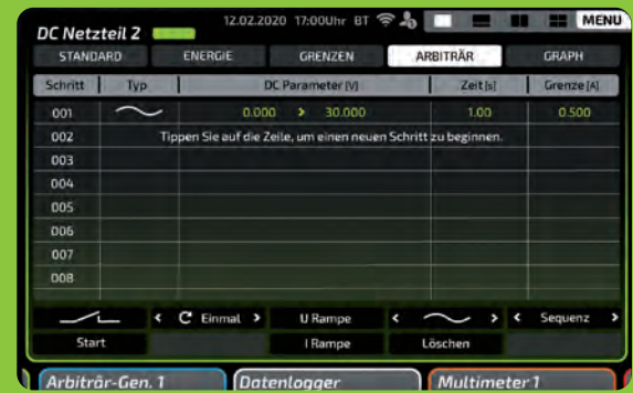
Rampengenerator: Durch das 8-Zoll-Display können beliebige Sequenzen ohne Programmieraufwand direkt eingegeben werden – für die tägliche Arbeit ein entscheidender Vorteil. Alternativ können die Sequenzen über die Schnittstelle übertragen und gestartet werden.
