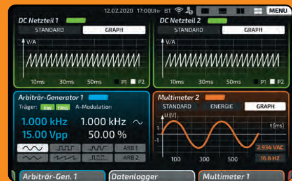
Quattro-Screen: In jedem der Splitscreens bleibt das Gerät bedienbar. Auch die grafische Messwertdarstellung kann im kleinsten Screen (Quattro-Screen) parallel zu anderen Geräten wie z.B. DC-Netzteilen oder AC-Quellen parallel genutzt und bedient werden.
