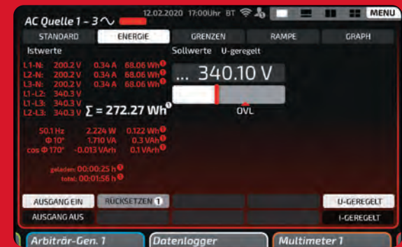
3-phasige AC-Quellen mit Leistungs- und Energiemesser: Bei 3-phasigen AC-Quellen ist ein 3-phasiger Leistungs- und Energiemesser im Lieferumfang beinhaltet. Die Ist-Spannungen zwischen allen Phasen und N werden gleichzeitig angezeigt.
