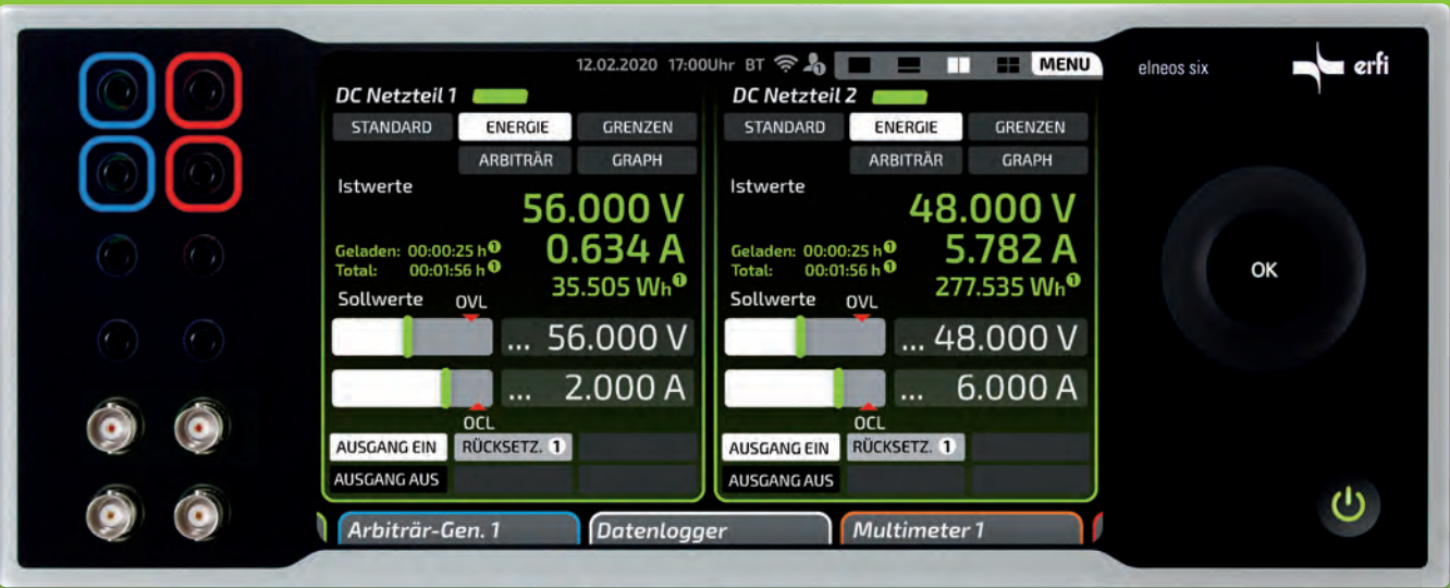
Halfscreen: Ein Doppelnetzteil lässt sich durch den Splitscreen von mehreren Nutzern gleichzeitig bedienen. Die Geräte-Auswahlleiste am Bildschirmrand ermöglicht den Zugriff auf andere Geräte.
