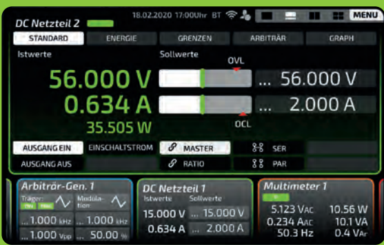
2/3-Screen-Modus: Nach Eingabe der Werte ist die Geräteleiste durch Wischgesten am Display oder durch 3D-Gesten (Smartscroll) leicht verschiebbar. Die Geräte gleiten horizontal elegant über den Bildschirm.
