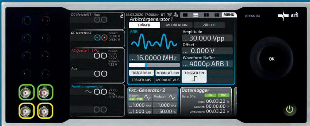
Neues Connectionpanel: Das Panel wird durch eine Wischgestik von rechts in den Bildschirm geslidet und die übrigen Bildschirmhalte schieben sich zusammen. So bleiben bei eingeblendetem Connectionpanel alle Anschlüsse sicht- und bedienbar. Keine Verschiebung der Messwertanzeigen.
