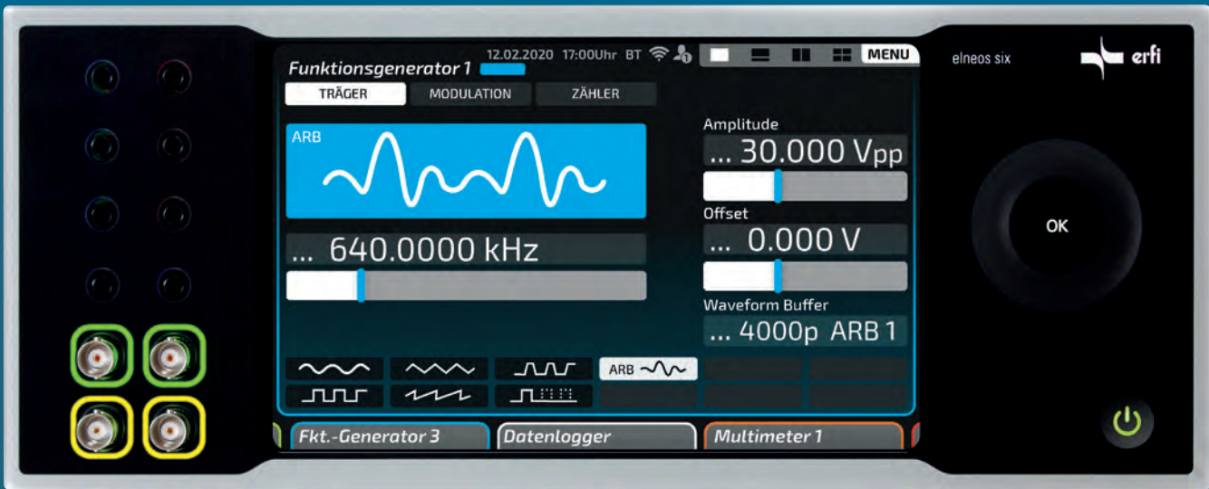
Arbiträrfunktionalität: Zwei beliebige Kurvenformen können übertragen sowie ausgewählt und mit max. 8.192 Gesamtabtastpunkte im Gerätespeicher abgelegt werden.
