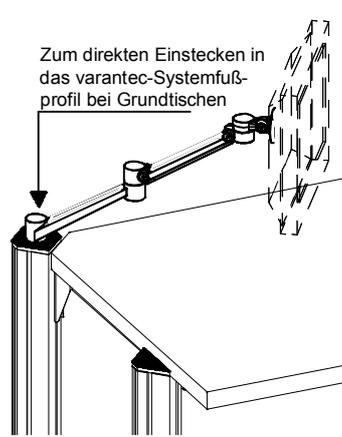
Zum direkten Einstecken in das varantec-Systemfußprofil bei Grundtischen
