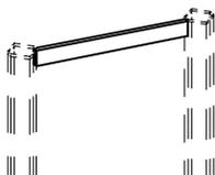
Qualitäts-Profilrohr aus Stahl zur zusätzlichen Stabilisierung
