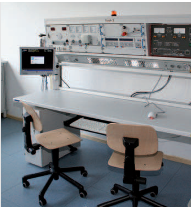
Gerätecockpits bestückt mit Gerätesystem highlab.
