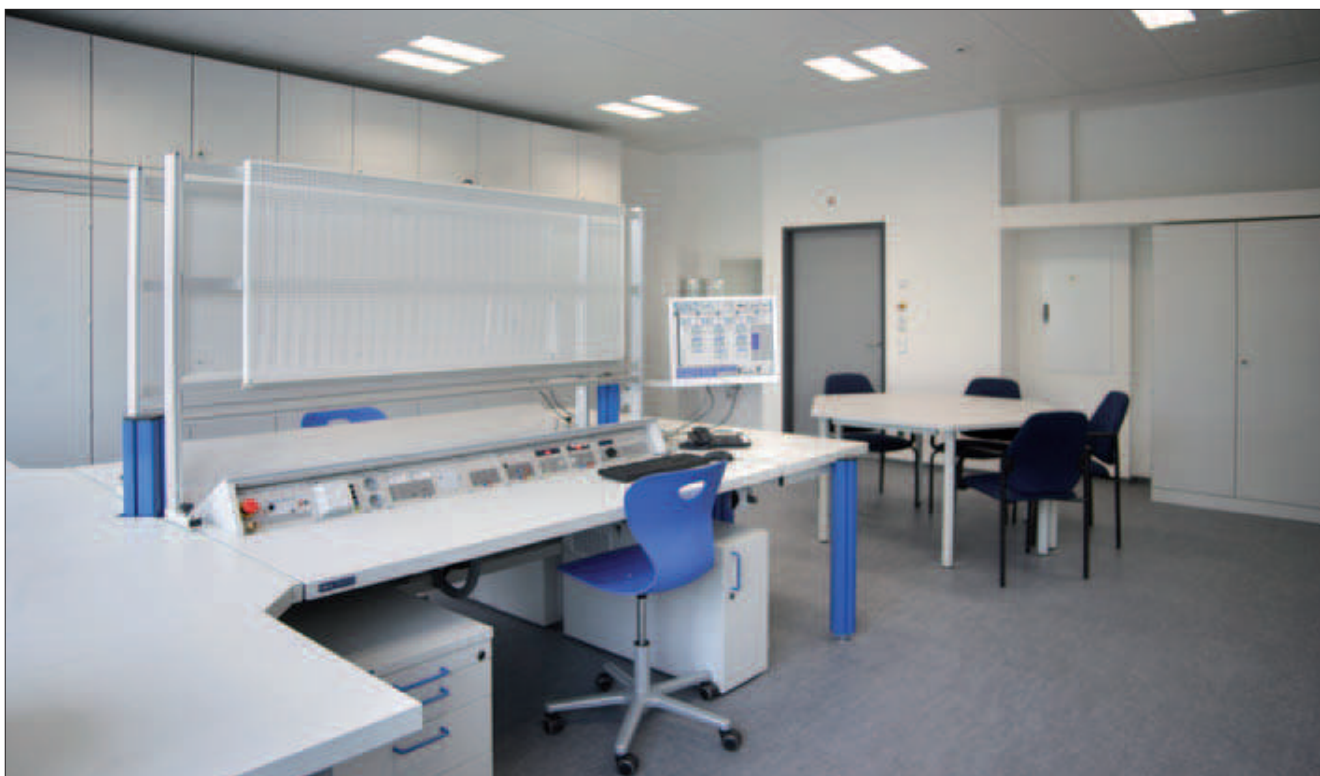
Labortisch mit Netzteil, Stelltrenntrafo, Funktionsgenerator u.v.m. bestückt. Im Hintergrund: Schrankwandsystem und Besprechungsinsel mit Trapeztischen
