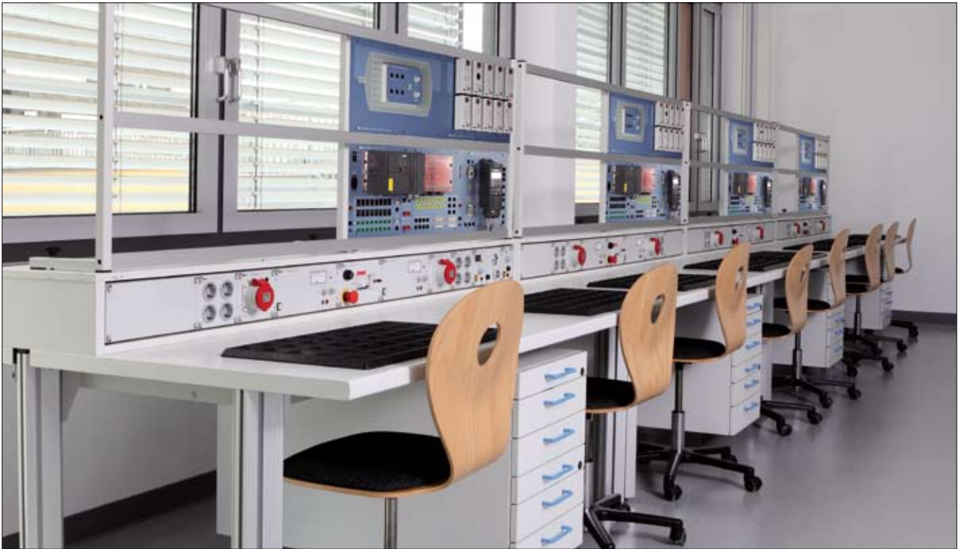
Laborsystemeinrichtung varantec mit 19"-Gerätessystem basic und erfi-Didactic-Lehrmitteln. (VDE-Versuche, Motorfehlersimulatoren, SPS-S7-Board und Frequenzumrichterboard für die Automatisierungstechnik).
