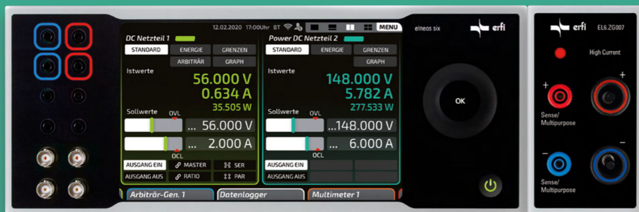
Kombinatorik: Selbst in Kombination mit den längsgeriegelten Netzteilen (hier NT1) arbeiten die Powernetzteile problemlos zusammen.
