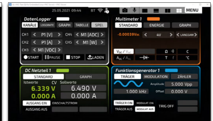
Alle Originalscreens sind mit voller Gerätefunktionalität am Endgerät bedienbar.
