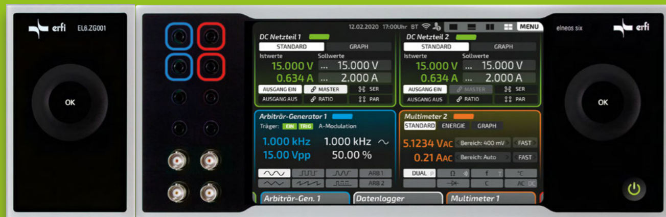
Doppelnetzteil mit 2. zusätzlichem Wheel: Das optionale 2. Wheel kann wahlweise links oder rechts vom Steuerzentrum positioniert werden.
