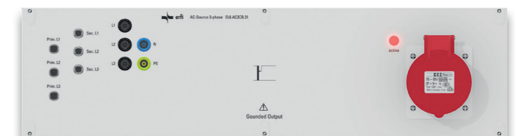
Zusatzeinschub mit Alufont für AC-Quelle 3-phasig, nicht erdfrei, 3 HE/95 TE Ausgänge (abges.): 5 SLB 1 , 1 CEE-Steckdose 16 A Anzeige: RGB-LED für Ausgang active Best.-Nr. EL6.AC3CB.31
