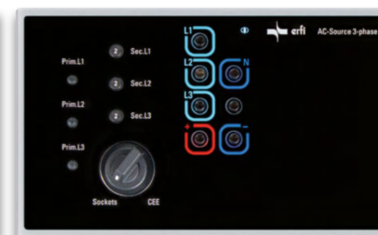
Abb. 7: elneos six Buchsenbeleuchtung der AC-Quellen
