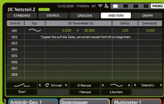
Rampengenerator: Durch das 8-Zoll-Display können beliebige Sequenzen ohne Programmieraufwand direkt eingegeben werden – für die tägliche Arbeit ein entscheidender Vorteil. Alternativ können die Sequenzen über die Schnittstelle übertragen und gestartet werden.
