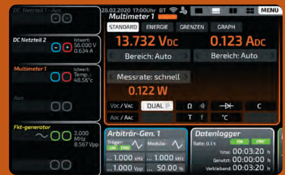
Leistungs- und Energiemessung: Der Leistungs- und Energiemesser in Fullscreen-Modus mit Anzeige aller relevanten Energiewerte sowie der Wirkenergie und den Crestfaktoren für U und I inkl. Zoomfunktion.
