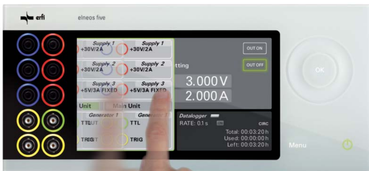
Ouverture du panneau de connexion par le contact avec doigt.
