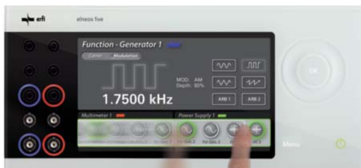
Sélection de l'appareil par la barre Icon par le contact avec 1 doigt.
