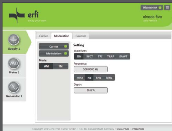
Modulation per Webserver: Der Webserver ermöglicht auch die Fernsteuerung der AM, FM und PWM-Modulation.
