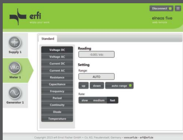
Fernsteuerung Digitalmultimeter: Der Webserver ermöglicht die vollständige Fernsteuerung und die Messwertdarstellung aller Funktionen.
