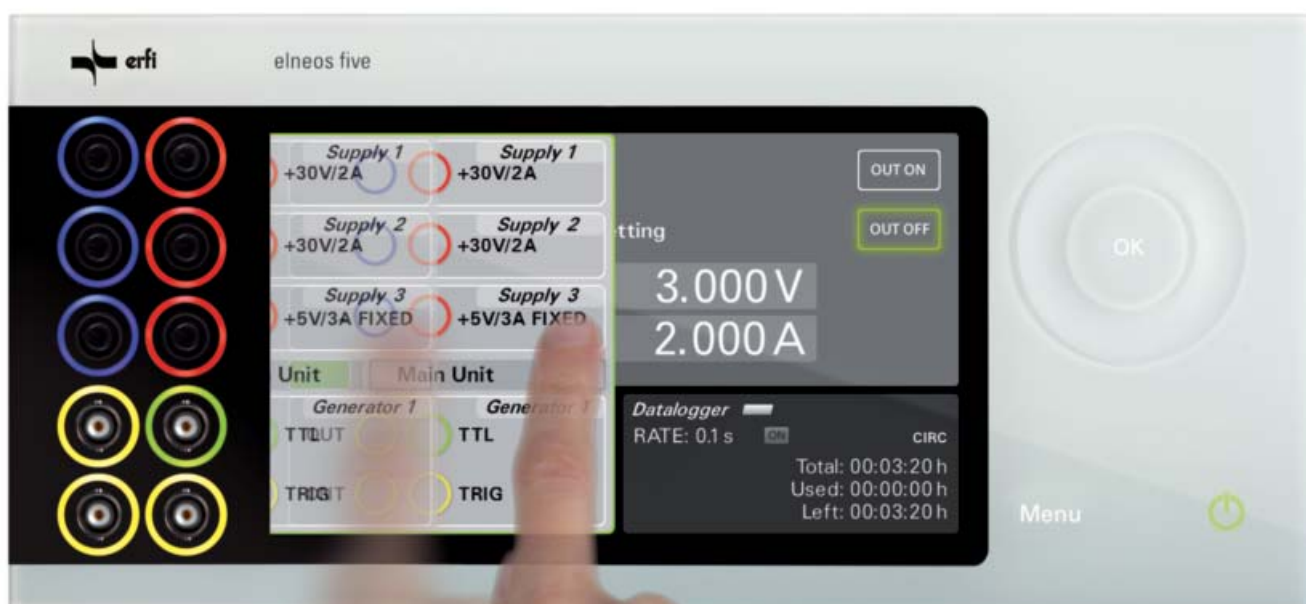
Öffnen des Connectionpanels per 1-Finger-Geste.
