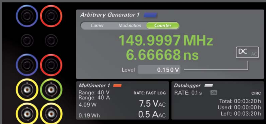
Eingebauter Zähler: Erlaubt die Erfassung von AC und DC-Signalen sowie die Einstellung des Triggerlevels im DC-Bereich im Standard bis 150 MHz. Optionale Erhöhung des Messbereiches auf 1,5 GHz (Best.-Nr. EL5.F1G).
