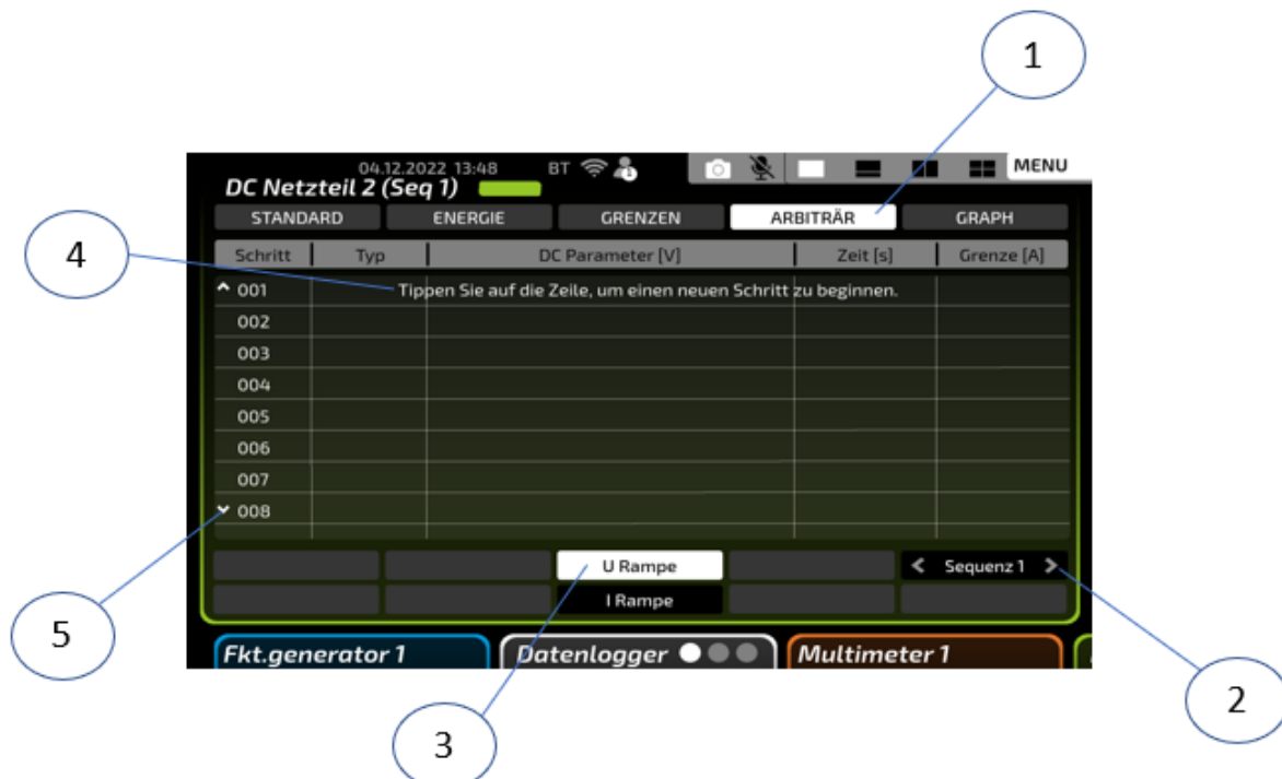
Abbildung 7-15 elneos six Rampenbetrieb
