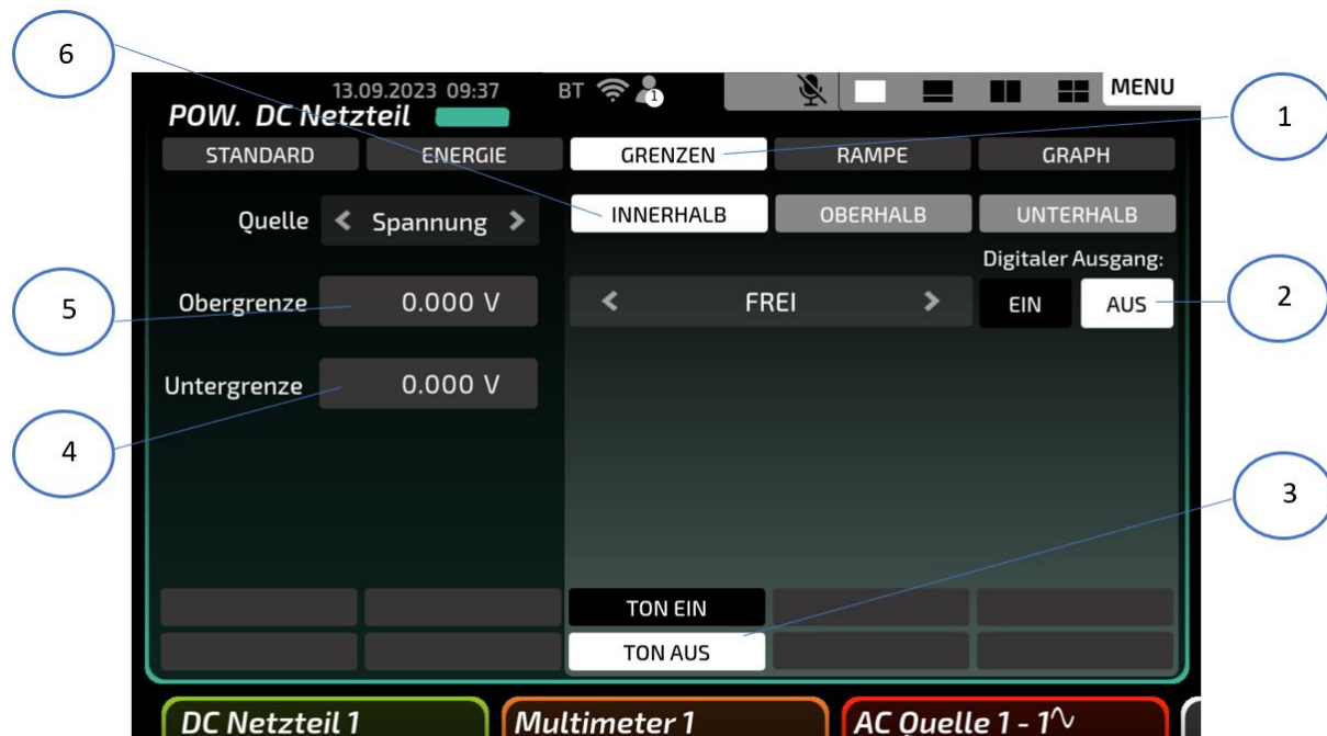
Abbildung 9-3 elneos six Powernetzteil LIMITS Parameter
