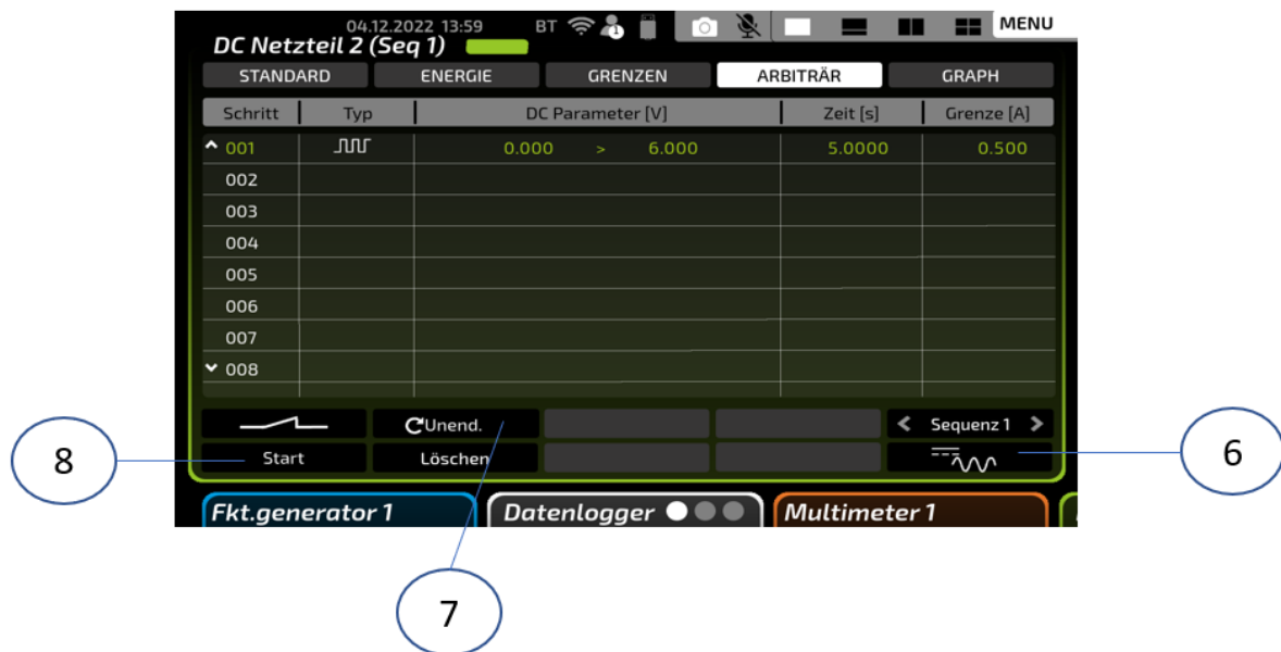
Abbildung 7-17 elneos six Rampenbetrieb
