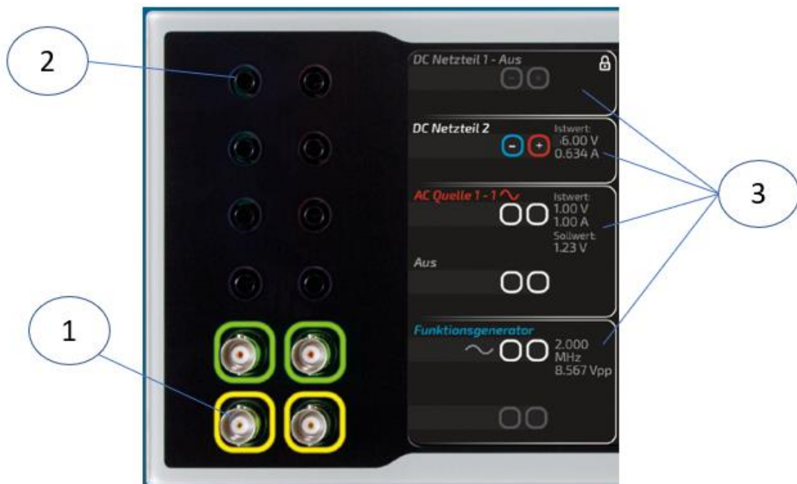
Abbildung 12-5 elneos six Belegung BNC-Buchsen (1)
