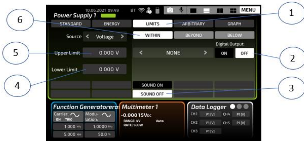
Abbildung 13-3 elneos six Signalstromversorgung LIMITS Parameter
