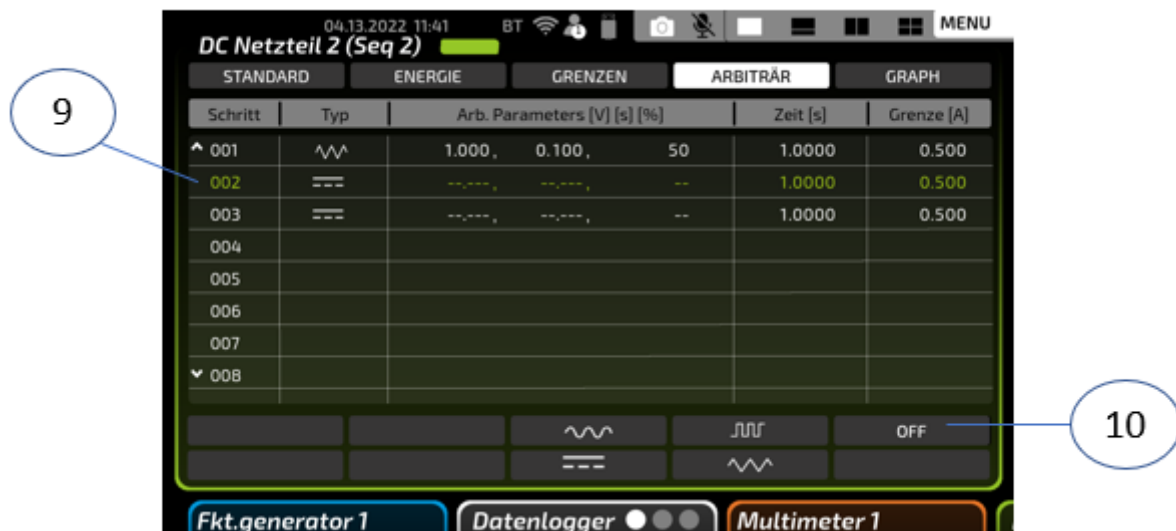
Figure 8-3 elneos six Arbiträrgenerator Löschen eines Schrittes in der Sequence
