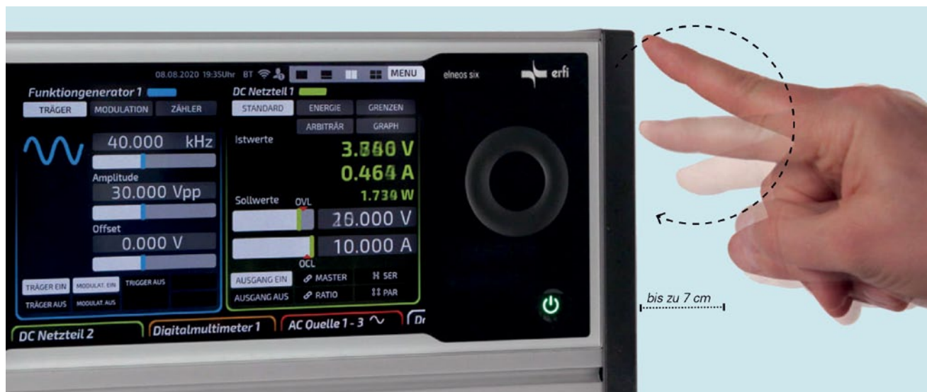
Das berührungslose Bedienkonzept minimiert potentielle Kontaminationspunkte und erhöht so die Hygiene im Elektroniklabor.
