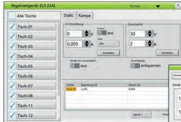
Gleichzeitige Detaileinstellung der Regelnetzgeräte an allen Labortischen.
