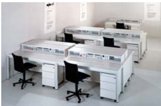
Elektronik-Laborraum mit elektromotorisch versenkbaren Tischaufbauten für optimale Nutzbarkeit der Räumlichkeiten. 19Zoll/3HE-Geräteaufbauten in ausgefahrenem Zustand.
