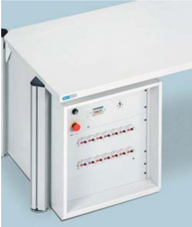
19Zoll-Standcontainer mit Systembreite 562 mm, nutzbare Fronthöhe 13HE/19Zoll; 1HE= 44,45 mm. Der 19Zoll-Container eignet sich zur Aufnahme von Geräten in 19Zoll-Technologie. Stabile Gleitschienen können im Schrankinnern für tiefe Geräte eingebaut werden. Die 19Zoll-Container eignen sich insbesondere zur Aufnahme von Raumunterverteilungen an Lehrerarbeitsplätzen in Ausbildungsstätten. Auf Wunsch kann der 19Zoll-Unterschrank mit einer frontseitigen Tür ausgestattet werden.
