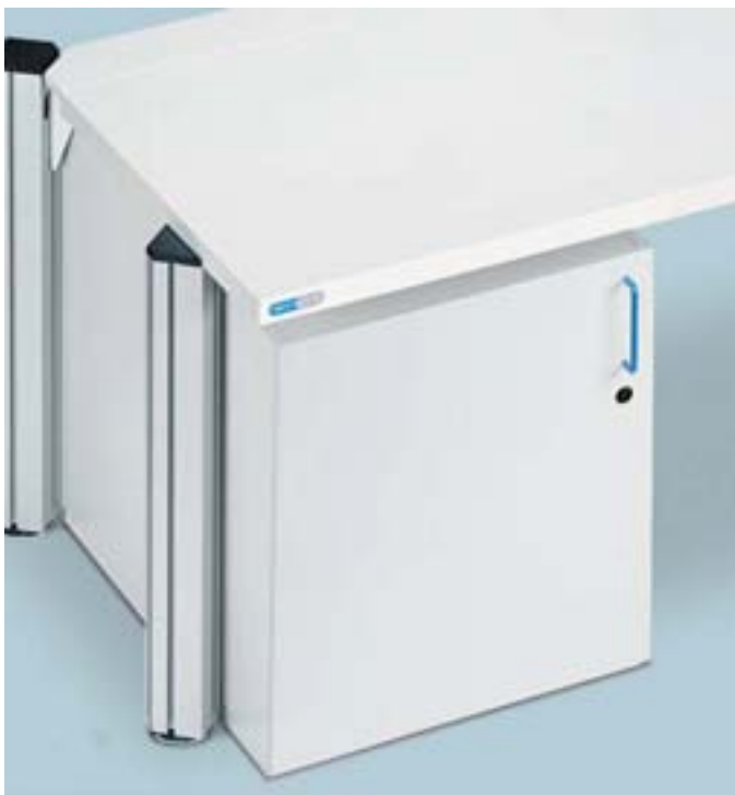
19Zoll-Standcontainer mit Systembreite 562 mm, nutzbare Fronthöhe 13HE/19Zoll; 1HE= 44,45 mm. Der 19Zoll-Container eignet sich zur Aufnahme von Geräten in 19Zoll-Technologie. Stabile Gleitschienen können im Schrankinnern für tiefe Geräte eingebaut werden. Die 19Zoll-Container eignen sich insbesondere zur Aufnahme von Raumunterverteilungen an Lehrerarbeitsplätzen in Ausbildungsstätten. Auf Wunsch kann der 19Zoll-Unterschrank mit einer frontseitigen Tür ausgestattet werden.
