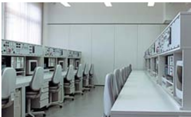
Versenktische mit Kombinationsaufbauten. Im unteren Bereich links ausgestattet mit dem Einsatzplattenprogramm acto, oberhalb Aufnahme für SPS-Steuerung, rechts davon mit Tastaturgarage und Monitorfach. Diese Einheit kann komplett versenkt werden. Darüber befindet sich ein 19Zoll/6HE-Geräteaufbau. Im ausgefahrenen Zustand werden Mechatroniker ausgebildet.
