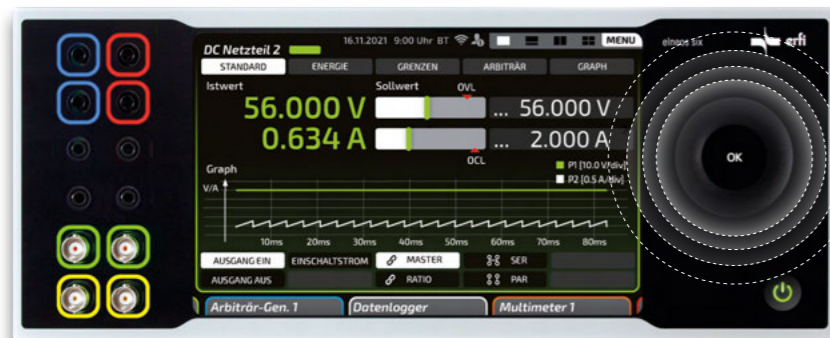
Рис. 2: elneos six основной блок. 8 дюймовый экран и сенсорное кольцо управления
