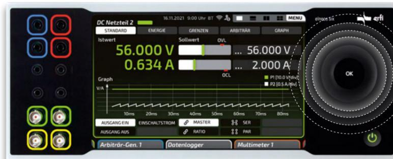
Fig. 2: *elneos six* avec écran de 8" et Airwheel avec retour tactile
