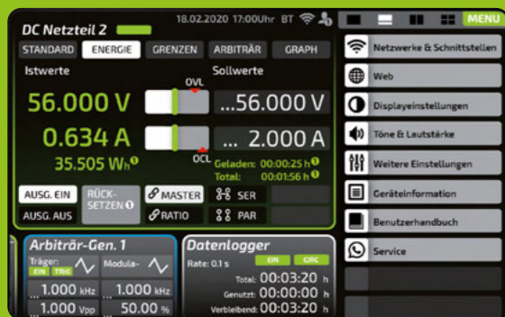
Menü-Leiste und dynamische Bildschirmskalierung: Bei Einblendung der Menü-Leiste schiebt sich der Screen dynamisch zusammen und bleibt während der Einblendung komplett lesbar und bedienbar. Störende Überblendungen von Menüs werden damit vollständig vermieden.
