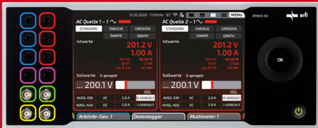
Halbscreen: Beispiel der gleichzeitigen Gerätedarstellung von zwei AC-Quellen im Halbscreen-Modus. Alle anderen Geräte bleiben durch die Geräteaufleiste am unteren Bildschirmrand erreichbar.
