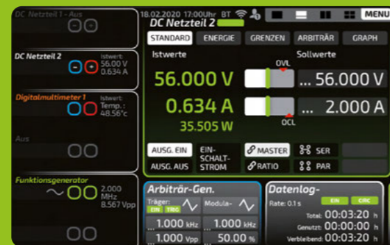
Connectionpanel und Bildschirmskalierung: Bei Einblendung der Connectionpanels wandern alle Screens nach rechts und passen sich in der Größe an. Gut sichtbar werden die Werteangaben im Connectionpanel der aktuellen Belegung dargestellt.
