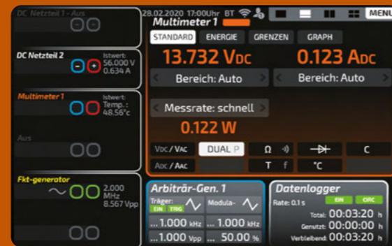
Connectionpanel mit Istwert-Anzeige: Das neue Connectionpanel zeigt alle Messwerte an den Aus- bzw. Eingängen an. Der Screen mit den Geräteanzeigen skaliert sich automatisch. Das Connectionpanel stellt somit einen eigen Informationsscreen dar, der dauerhaft eingeblendet bleiben kann.
