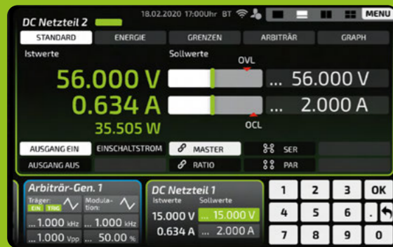
2/3-Screen-Modus: Regelnetzgerät im kleinen Fenster mit numerischem Tastaturfeld. Selbst in dem kleinen Fenster sind die Geräte bedienbar und es können Sollwerte eingegeben werden.
