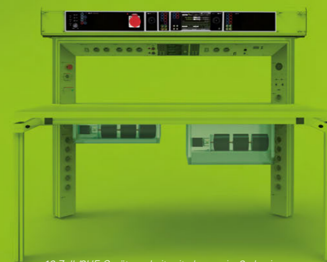
19-Zoll-/3HE-Gerätecockpit mit elneos six, 3-phasiger Einsatzplatte für den Anschluss der AC-Quellen, die im TechCube unter dem Tisch verbaut sind. Weiteres Wheel und Einschübe für 2. Digitalmultimeter und Powernetzteile.
