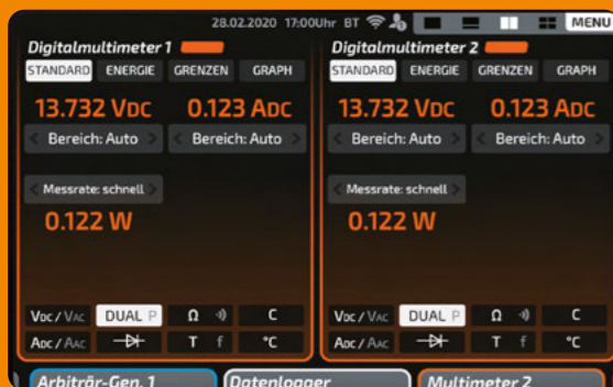
Zwei Digitalmultimeter im Halbscreen: Alle Bedienelemente beider Digitalmultimeter lassen sich gleichzeitig und unabhängig voneinander bedienen. Die optionale Dualmessung ermöglicht jedem Digitalmultimeter die gleichzeitige Erfassung von Strom und Spannung im AC und DC-Bereich.
