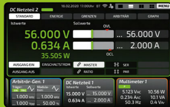
2/3-Screen-Modus: Nach Eingabe der Werte ist die Geräteleiste durch Wischgesten am Display oder durch 3D-Gesten (Smartsroll) leicht verschiebbar. Die Geräte gleiten horizontal elegant über den Bildschirm.
