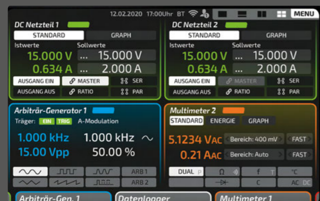
Quattro-Screen: mit Paralleleingabe in allen 4 Screens gleichzeitig.
