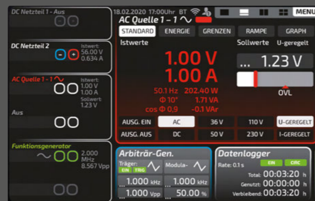
Connectionpanel mit Live-Messwertanzeige: Der restliche Screen wird bei Einblendung des Connectionpanels dynamisch skaliert und ist parallel immer bedienbar.
