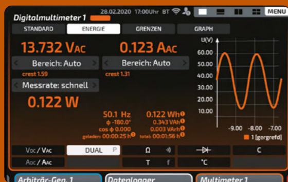
Skalierbare grafische Messwertanzeige: In der oberen Hälfte stellt der Leistungsmesser alle Messdaten dar. Gleichzeitig können im Fullscreen-Mode weitere Geräte in der Smartscroll-Leiste angewählt werden.
