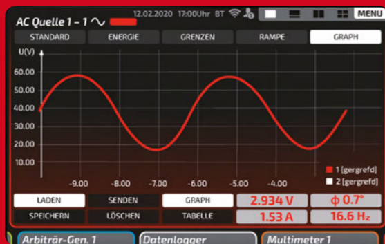
Datenlogger und grafische Messwertdarstellung: Visualisierungen und Echtzeitaufzeichnungen von frei programmierbaren Rampenfunktionen zur Verfolgung von Spannungs- und Stromverläufen. Die aktuellen Werte werden immer eingeblendet. Alternativ können die Daten in Tabellenform angezeigt werden.
