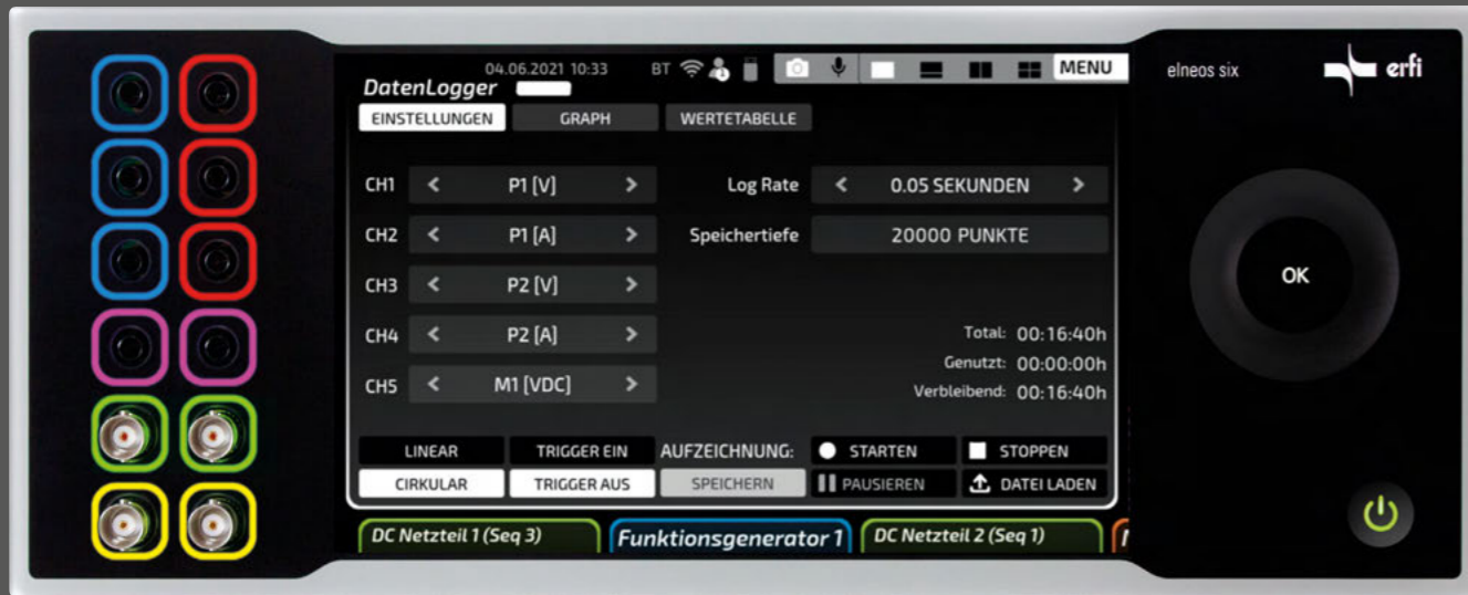
Messwertdarstellung, Messgeräte (DMM, P-Messer) und Stromversorgungen (AC, DC): Über den Datenlogger können 5 unterschiedliche Messgrößen ausgewählt und Messrate sowie Speichertiefe (bis zu 500.000 Messpunkte) ebenfalls definiert werden.
