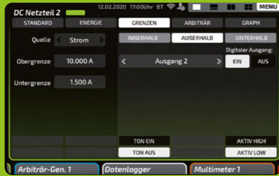
Limiter: Der Limiter erlaubt die freie Überwachung von Spannungs- und Strombereichen in Verbindung mit Grenzen. Jeder Zustand kann mit einem akustischen Signal und einem frei wählbaren digitalen Ausgang gekoppelt werden.
