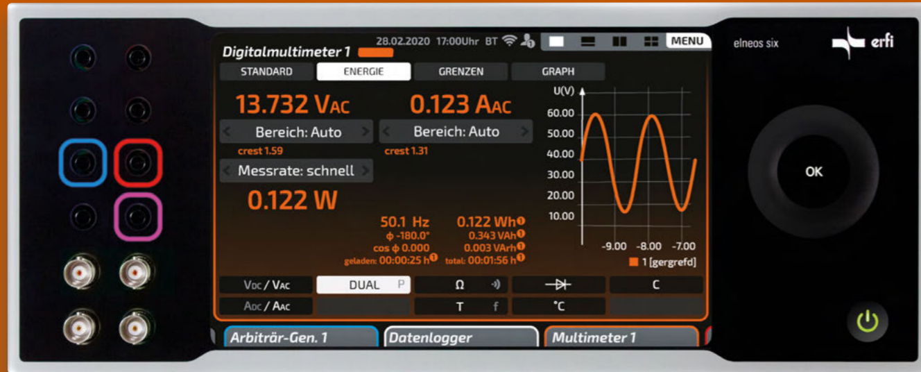
Leistungs- und Energiemessung: Der Leistungs- und Energiemesser in Fullscreen-Modus mit Anzeige aller relevanten Energiewerte sowie der Wirkenergie und den Crestfaktoren für U und I inkl. Zoomfunktion.
