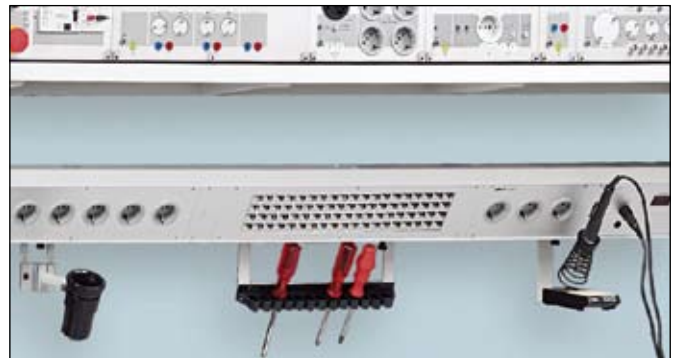
Un rail profilé en aluminium fixé sur l'arrière du profilé-support permet le montage de composants fonctionnels supplémentaires tels que tournevis électriques, porte-outils, tôle perforée, plateau tournant pour petites pièces, plateforme supportant des appareils etc. Grâce à son support, le fer à souder se situe au-dessus du plan de travail. Le poste de brasage étant intégré dans le profilé-support, cela crée plus d'espace disponible et plus d'ordre sur le plan de travail.
