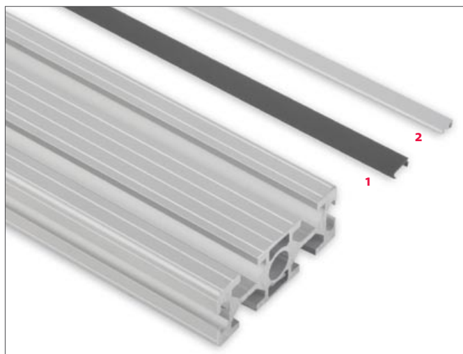
1 = Clipsprofil anthrazit für 17 mm Nuten (seitliche Nuten) 2 = Clipsprofil aluminium-natur für 12 mm Nuten (front- und rückseitige Nuten)
