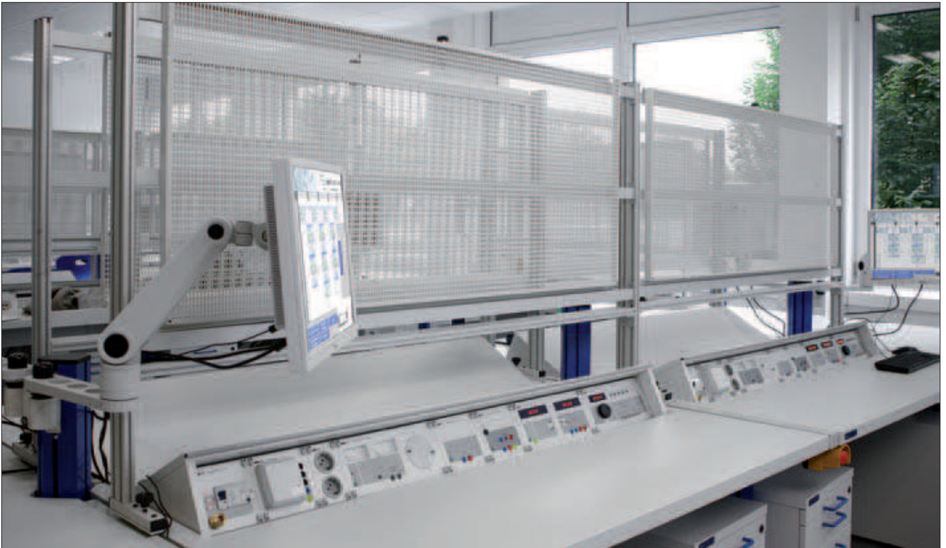
19"-highlab-Gerätesystem im 3HE/19"-Schwenkaufbau, verschiebbarer Experimentierahmen mit Lochblech.
