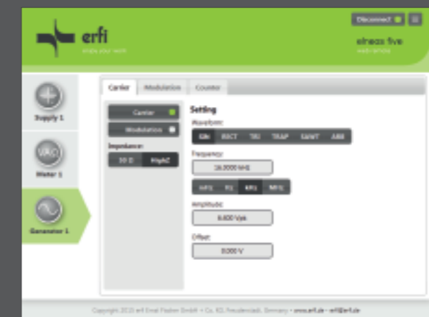
Fernsteuerung Funktionsgenerator und schneller Signalbiträgergenerator: Alle Parameter des Funktions- und Signalbiträgergenerators sind fernsteuerbar.
