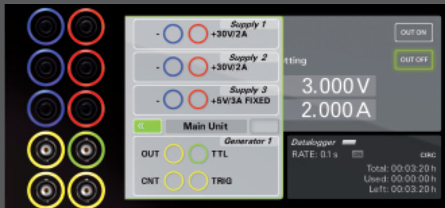
Connectionpanel: Es informiert über die Anschlussmöglichkeiten und welche Geräte verbaut sind.
