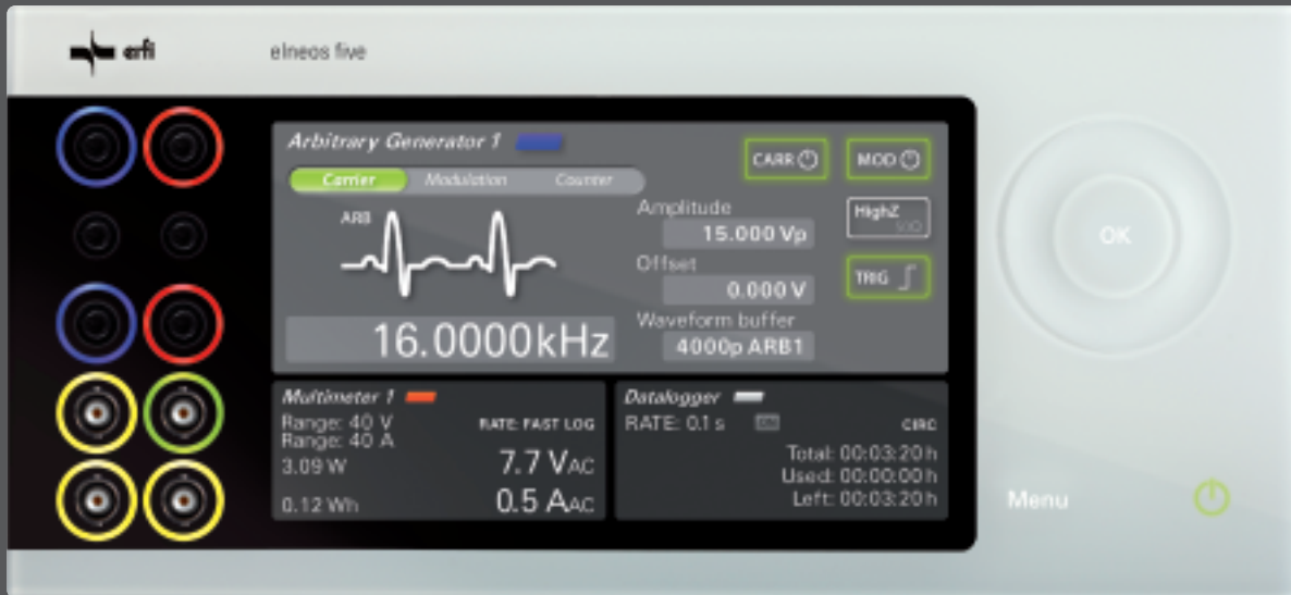
Arbiträrfunktionalität: Zwei beliebige Kurvenformen können über Schnittstelle übertragen werden.
