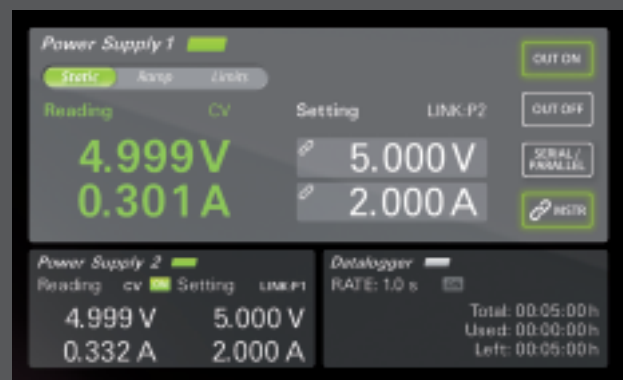
Optionale Komfortausstattung (Best.-Nr. EL5.C): Die Master-Slave-Funktion ermöglicht die Koppelung von zwei Regelnetzgeräten. Ein Slaverregelnetzgerät folgt einem Masterregelnetzgerät in Strom und Spannung nach.
