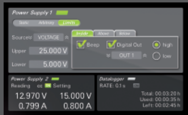
Limiter: Der Limiter erlaubt die freie Überwachung von Spannungs- und Strombereichen in Verbindung mit Grenzen. Jeder Zustand kann mit einem akustischen Signal und einem frei wählbaren digitalen Ausgang gekoppelt werden.
