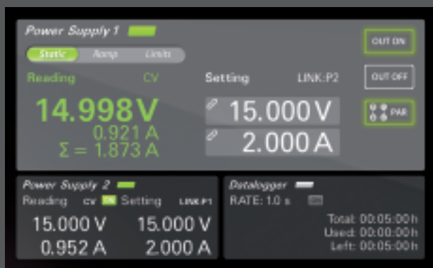
Optionale Komfortausstattung (Best.-Nr. EL5.C): Intern seriell/parallel verschaltete Netzteile mit Summenstromanzeige.
