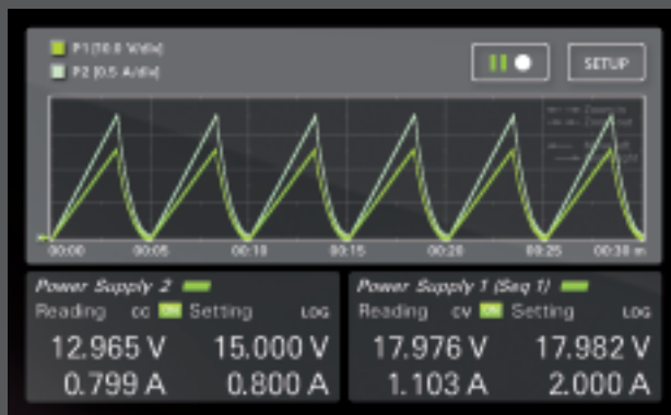
Datenlogger und grafische Messwertdarstellung: Grafische Visualisierungen und Echtzeitaufzeichnungen von frei programmierbaren Rampenfunktionen ermöglichen optimale Verfolgung von Spannungs- und Stromverläufen.
