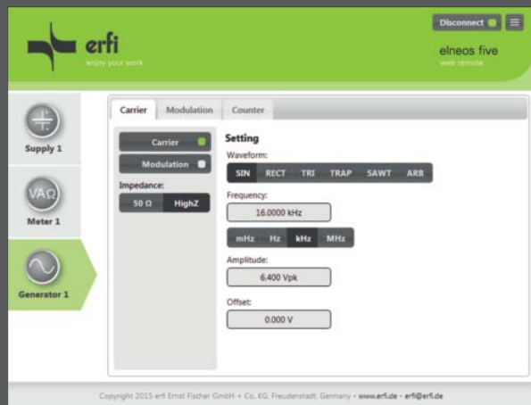
Télécommande générateur de fonction et générateur arbitraire de signal rapide: Tous les paramètres du générateur de fonction et du générateur arbitraire de signal sont télécommandables.
