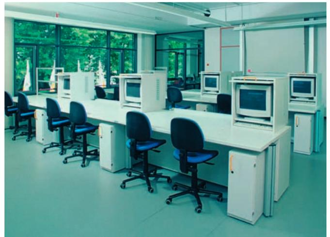
Versenktische im eingefahrenen Zustand. Die Sicht nach vorn ist frei für den Theorie- oder EDV-Unterricht.
