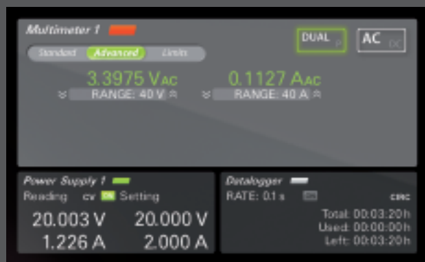
Optionale Dualmessung: Ermöglicht die gleichzeitige Erfassung von Strom und Spannung im AC- und DC-Bereich. (Best.-Nr. EL5.DUI)
