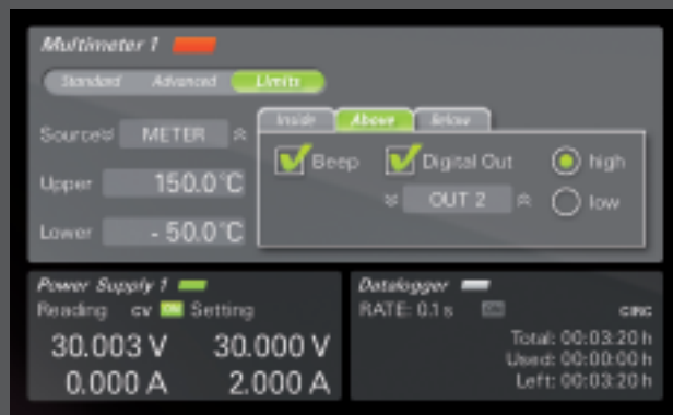
Limiter: Definierbare Grenzen können mittels Tönen und digitalen Ausgängen überwacht werden. Dabei kann das Verhalten für unterschiedliche Zustände gesteuert werden.
