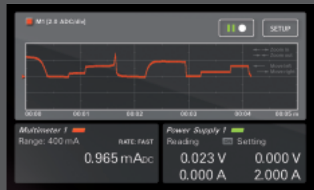
Datenlogger: Die Aufzeichnungsmöglichkeiten sind besonders in Verbindung mit dem Digitalmultimeter sehr wertvoll. Bis zu 4 Messkurven können gleichzeitig aufgezeichnet werden.
