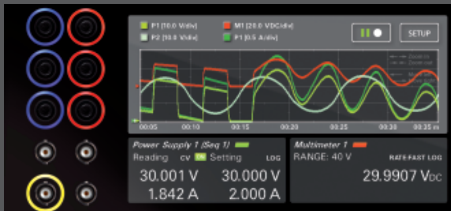
Die Doppelleistungsarbiträrgeneratoren können beide unabhängig voneinander programmiert werden. Durch den Datenlogger werden die Signale visualisiert.
