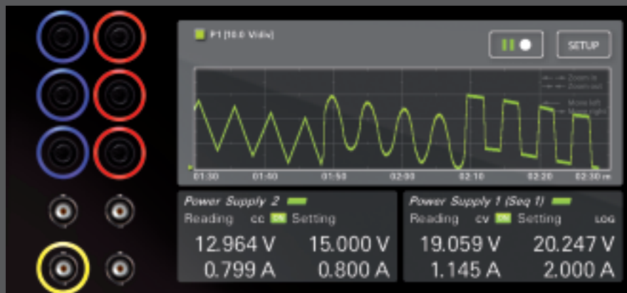
Erzeugung von beliebigen Kurvenformen mit der vollen Leistung des Regelnetzgerätes (stufenfreie Abarbeitung der Kurvenform).
